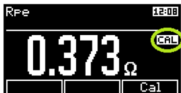
Obrázek 47: Chyba kalibrace odporu měřicích šňůr
