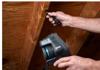
Pomocí vlhkoměru MR40 můžete ověřit, zda studené místo na termogramu označuje vlhkost
