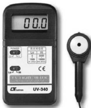
Digitální měřič UV záření detekuje spektrum od 290nm do 390nm. Má dva rozsahy 1 999  $\mu\text{W}/\text{cm}^2$  a 19 990  $\mu\text{W}/\text{cm}^2$ . Oddělená UV sonda s korekčním filtrem umožňuje měřit UV záření v optimální poloze.
