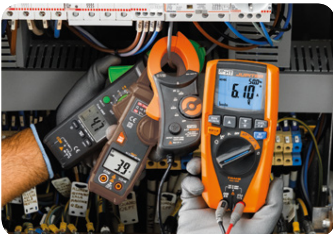
Srovnávací měření: 3.9A: s RMS kleštěmi - 4.7A: s TRMS kleštěmi 6.1A: korektní měření AC+DC TRMS clamp.
